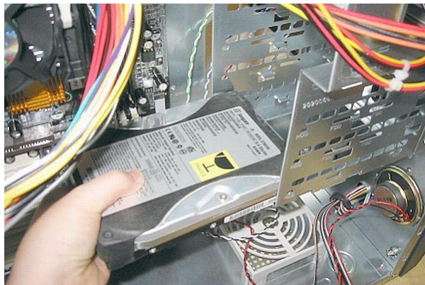
Hình 7.8. Lắp đặt ổ đĩa cứng
