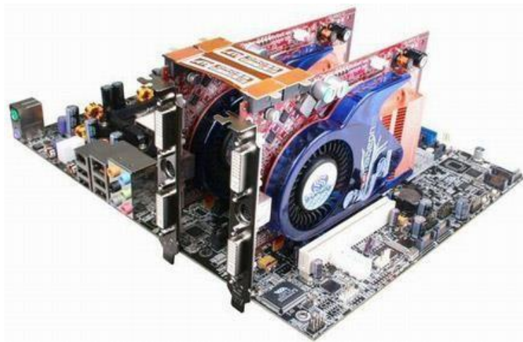
Hình 2.18. Công nghệ Dual Graphics sử dụng 2 Card đồ họa
