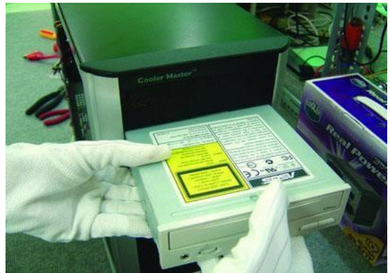
Hình 7.10. Lắp đặt ổ đĩa quang
